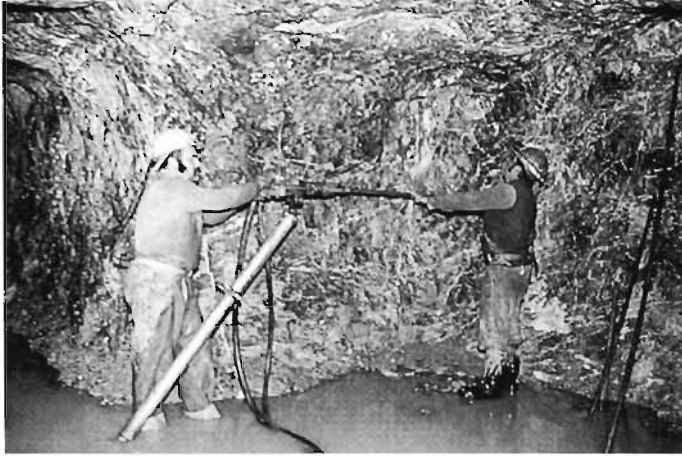
Bohrhammer auf pneumatischer Vorschubstütze beim Anbohren im Schwerspatkörper.
