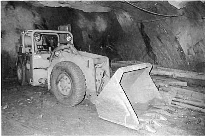
Dieselgetriebener Radlader zu Beginn des Einsatzes. Hinter der Vorderachse befindet sich eine Knickbrücke, die einen engen Kurvenradius erlaubt.
