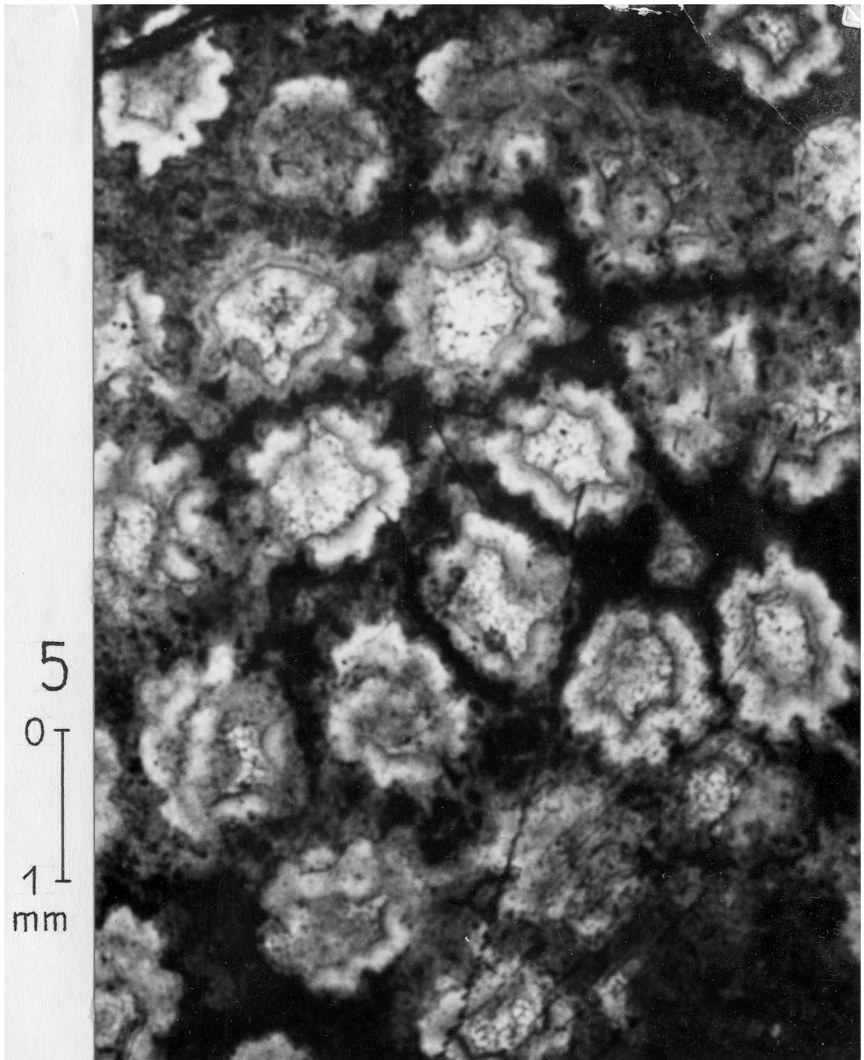
Fig. 5. — Section transversale relativement bien conservée. Dans le remplissage un dépôt périphérique bien marqué de silice.
