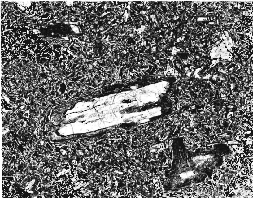
Magmatit der liegenden Lavadecke südlich Braunshausen. Große Einsprenglinge von Plagioklas (Feldspat) in Grundmasse Dünnschliff, achtfache Vergrößerung.
