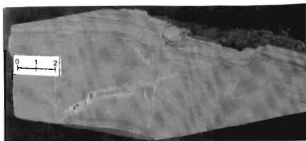
Abb. 17 FB2 / 38,6m / Serie V: Dehnungsklüfte in laminierten Ton-, Silt- und Sandsteinen, durch Entwässerung des Gesteins bedingt, führten zu einem grabenartigen Nachrutschen der oberen Partien in der Mitte des Handstücks. Risse sind mit Dolomit verheilt, Hohlräume in diesen Rissen als Relikte verblieben oder durch Lösung sekundär entstanden.
