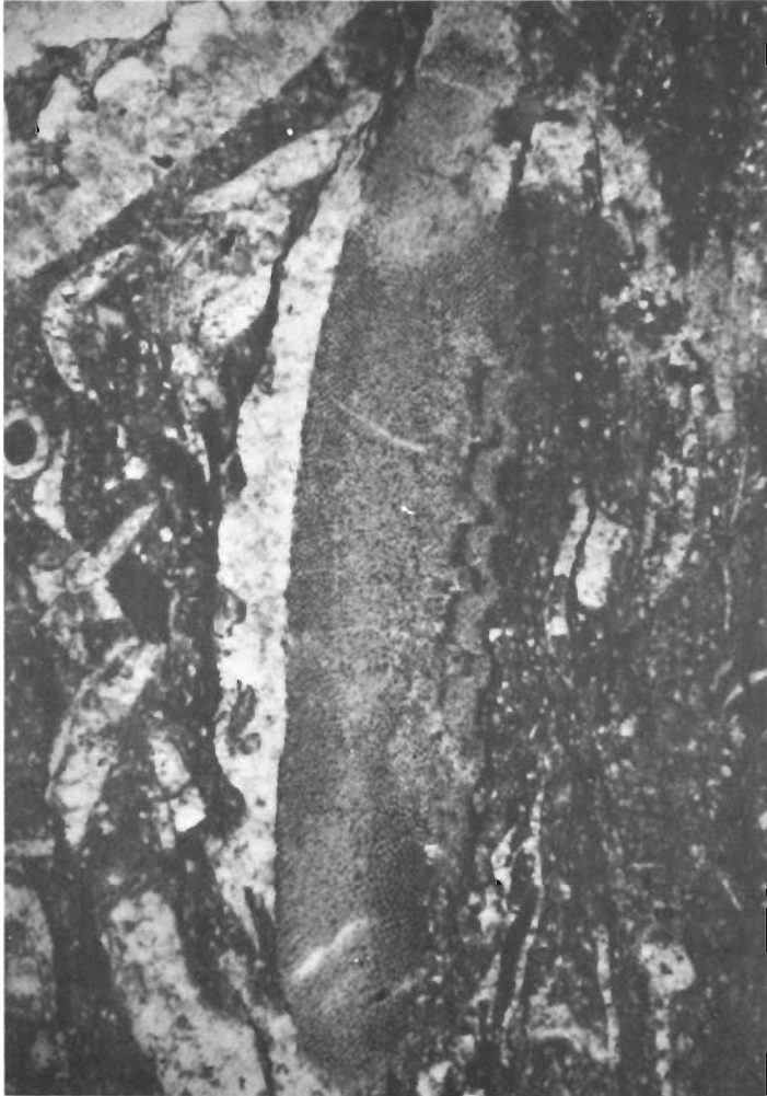
Abb.39 Teilweise verkieselter Riff- schuttkalk. Großer Echinoder- menrest. Größte Bildlänge 4 mm , ON Dünnschliff 288
