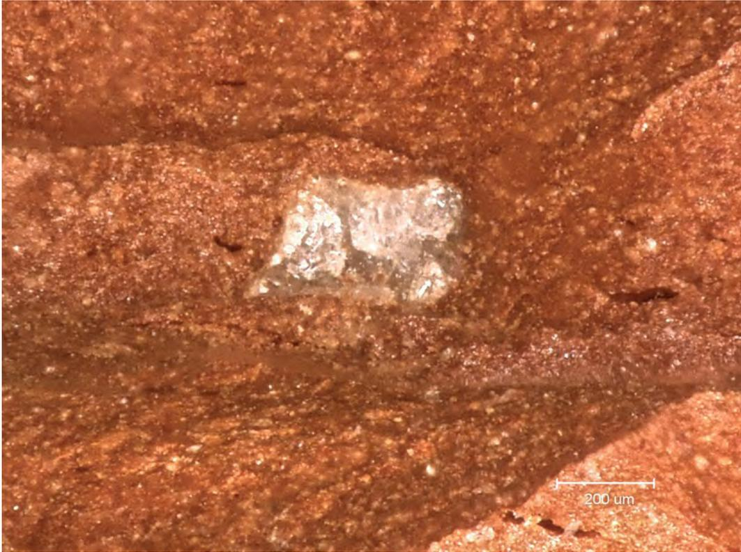
Bild 13/FK 44: Ausschnitt aus Bild 12/FK 44 (links oben), Quarzkorn und dunkle Streifen (Schmelzbildung)
