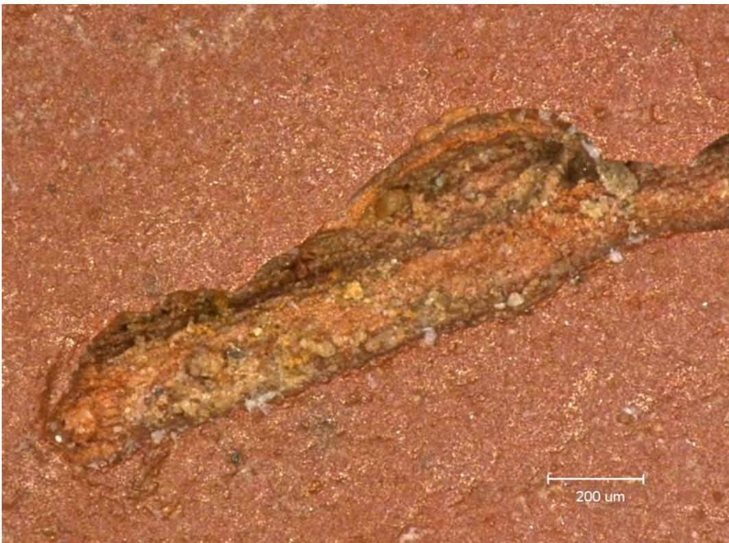
Bild 10/FK 44: Fraglicher Pflanzenrest mit größerem Korn umhüllt, nach Trocknung und Zersetzung verbleibt ein Hohlraum.
