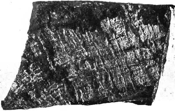
Abb. 12. Naturkoksstück mit Schrammen, die die Bewegungsrichtung des Lagergangs anzeigen. Die senkrecht auf diesen stehenden helleren Linien sind mit Intrusivgestein ausgefüllte Quersprünge. 1/2 nat. Größe. Aufn.: Guthörl.
