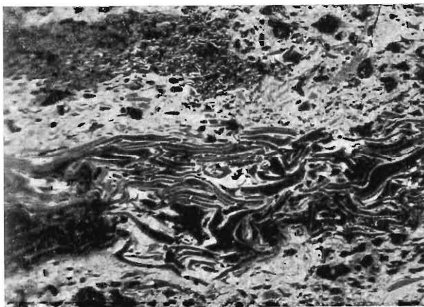
Abb. 23. Die zerdrückten Fusit- oder Semifusinit-Zellwände heben sich dunkel von der Koksgrundmasse ab. Nicols +. Anschliff unter Ol.  $v = 250$ .
